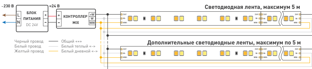
Схема 2. Подключение нескольких светодиодных лент с двух сторон Рекомендуется использовать для обеспечения равномерного свечения ленты по всей длине.
