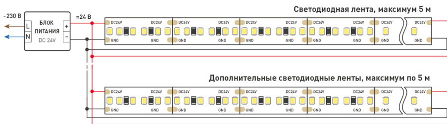
Схема 2. Подключение нескольких светодиодных лент с двух сторон. Рекомендуется использовать для обеспечения равномерного свечения ленты по всей длине.
