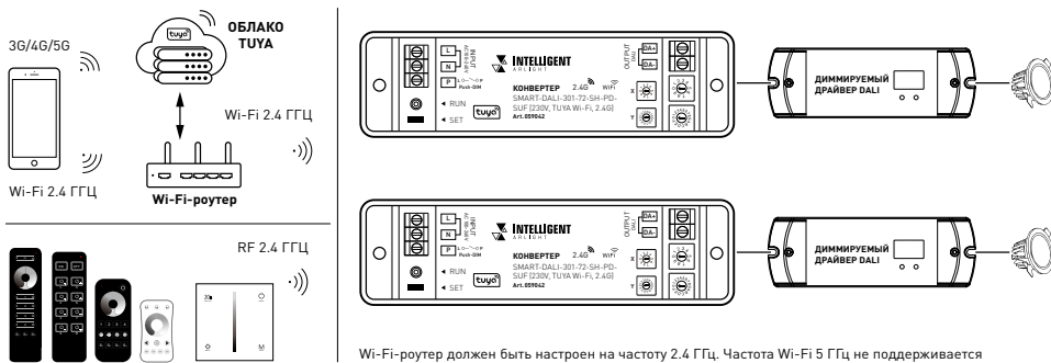
Рис. 2. Общая структурная схема построения системы управления освещением
