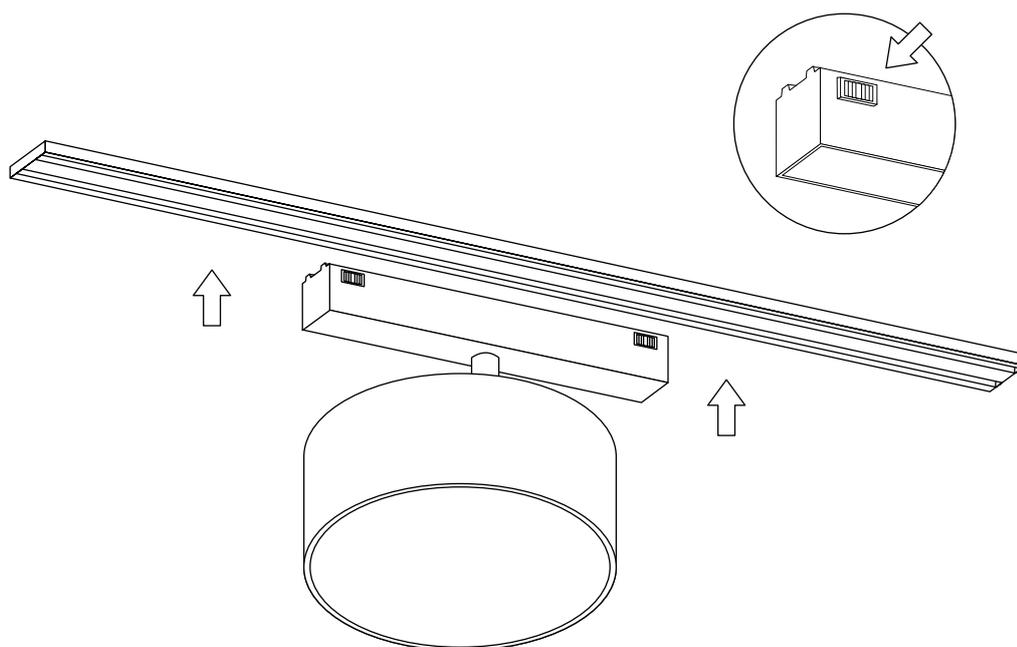
Рис. 2. Установка светильника
